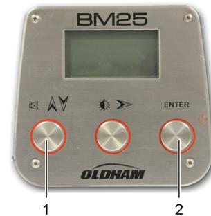
Рисунок 16: включения с выбором эталонного горючего газа
