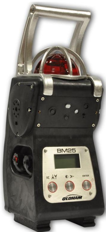
Рисунок 1: внешний вид газоанализатора.
