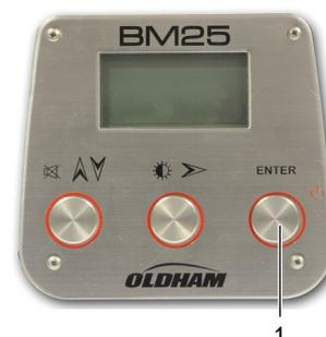
Рисунок 15: Стандартная процедура включения с помощью кнопки *Enter*.
