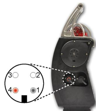
Рисунок 4: Разъём основной зарядки.
