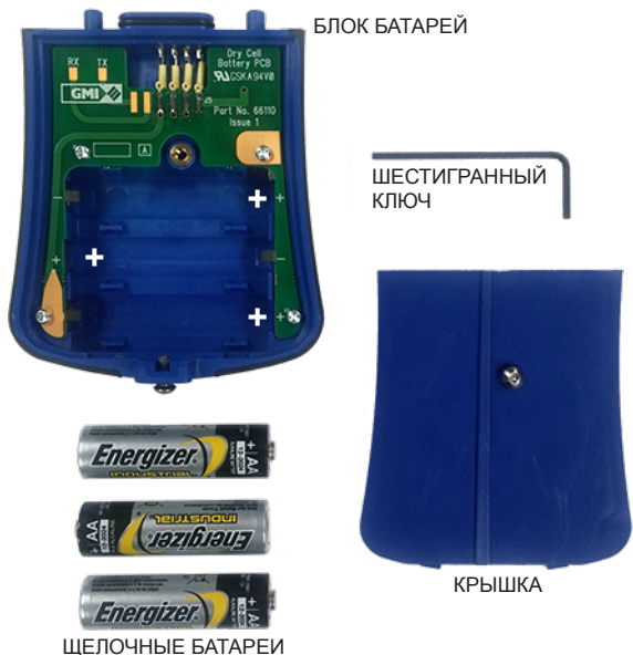
Рис. 4.13 Извлечение щелочных батарей
